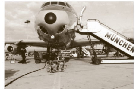
Ein BAUER Hochdruckkompressor am Münchner Flughafen liefert die Luft zum Starten der Turbine.
