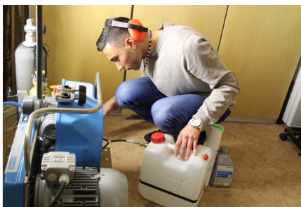
Assistent Issa Kayed beim Filterpatronentausch am OCEANUS
